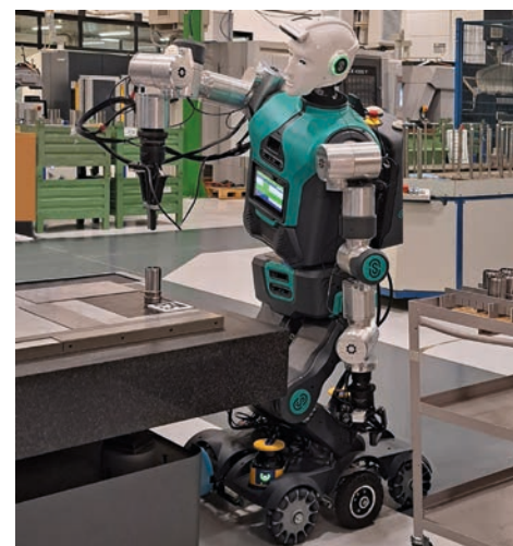
RoBee ha braccia e mani che gli consentono di ricoprire ogni tipo di task, dai più semplici gesti come indicare o contare a una solida presa per la movimentazione di oggetti fino a 5 kg di peso
