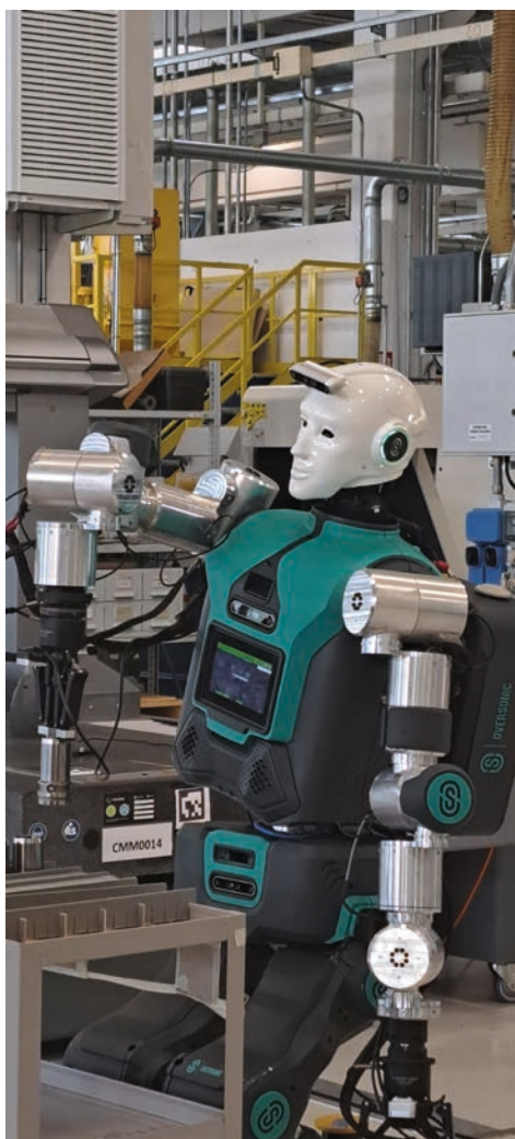
La struttura meccanica di RoBee è dotata di 40 giunti mobili e un set completo di sensori che gli consentono di vedere e navigare nello spazio circostante
